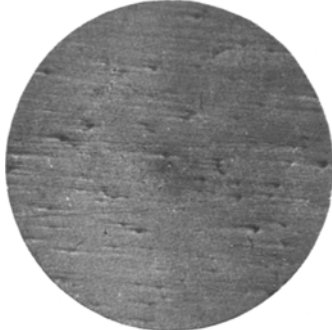
3. Messing mit 0.5727% Pb, Mittelstück d. elektrolyt. Metallfadens von 1.
