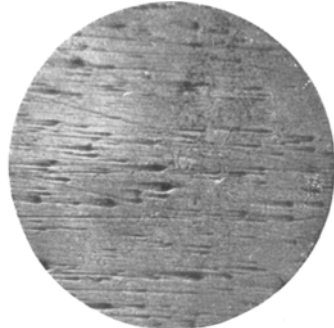
2. Messing mit 0.965% Pb nach d. Elektrolyse von 1. Anodenende.
